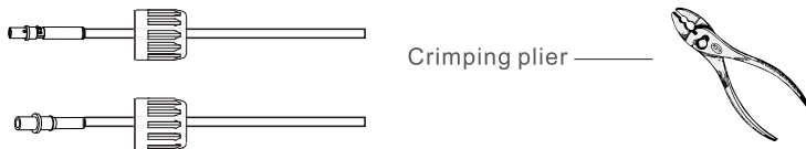
Rys. 3.4 Zaczepienie pin stykowy na przewodzie
