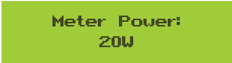
Figura 7.21 Funzione di esportazione-zero tramite contatore di energia acceso
