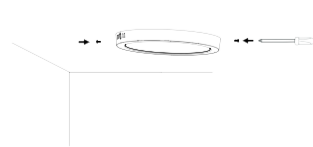
8. Fixați lumina și suportul cu șuruburi.
